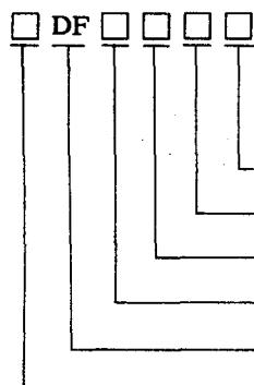
第1类电磁阀用阿拉伯数字1表示,第2类电磁阀不表示(5.2.2条)
